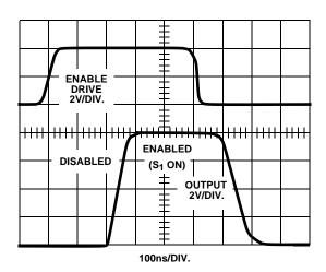
FIGURE 6C. WAVEFORMS FIGURE 6. ENABLE DELAYS
