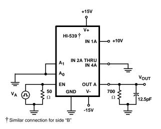
FIGURE 6B. TEST CIRCUIT
